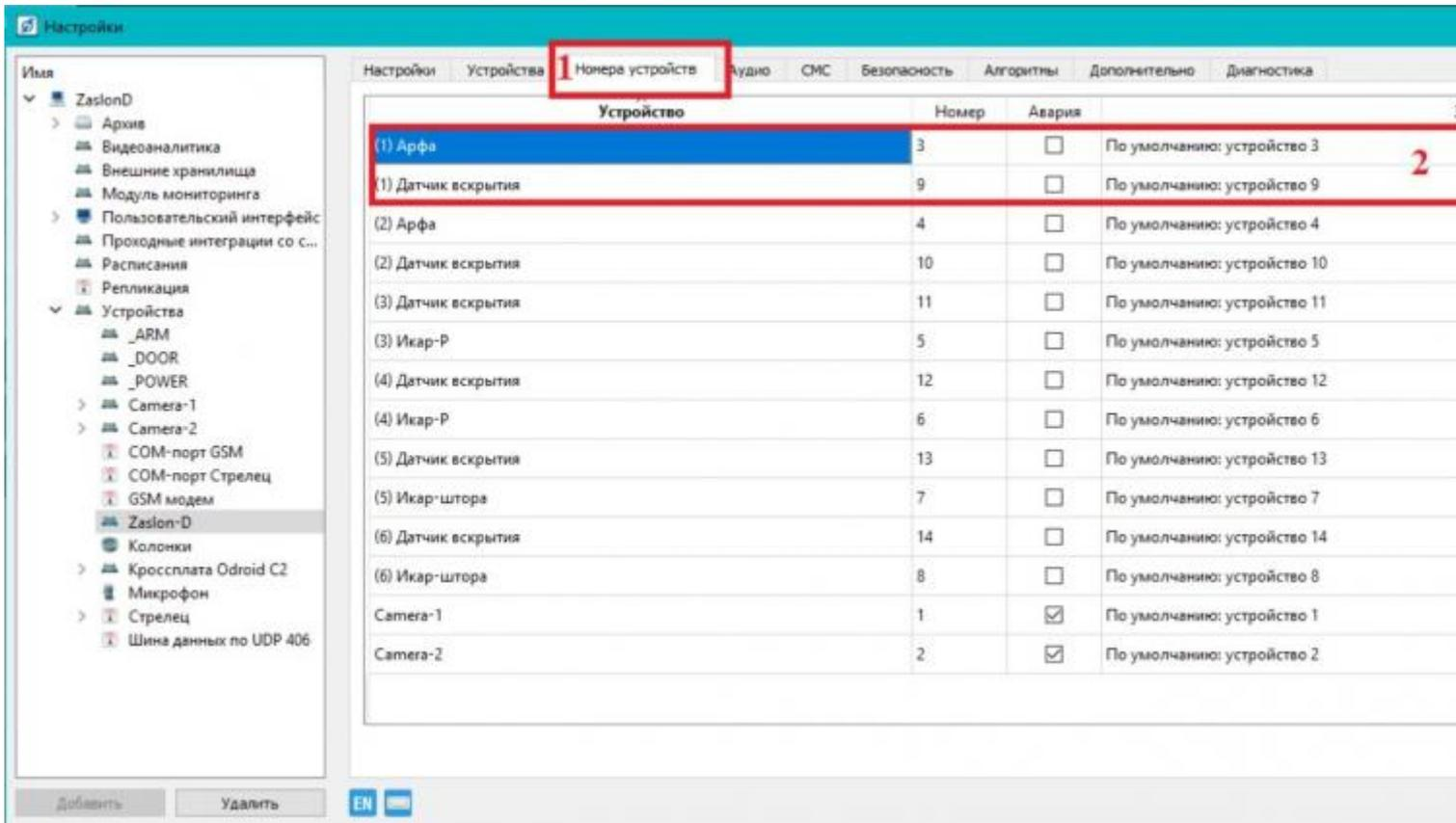
5. Во вкладке «Номера устройств» нажмите кнопку «Добавить». Откроется окно, в котором нужно развернуть графу «Стрелец», в ней найти и развернуть «(9) Арфа резерв». Теперь зажмите кнопку Ctrl на клавиатуре и выделите «(9) Арфа резерв» и «(9) Датчик вскрытия», как показано на скриншоте. После этого нажмите кнопку «ОК», а затем «Применить».
