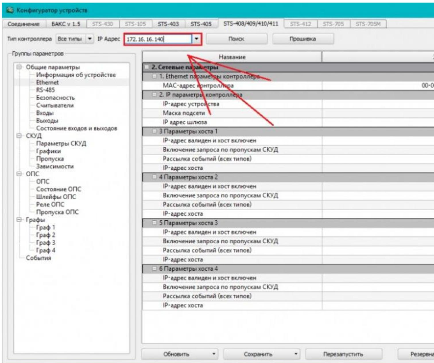
3. Зайдете в «Контроллер» и нажмите на кнопку «Прошивка». В открывшемся окне выберите файл прошивки.
