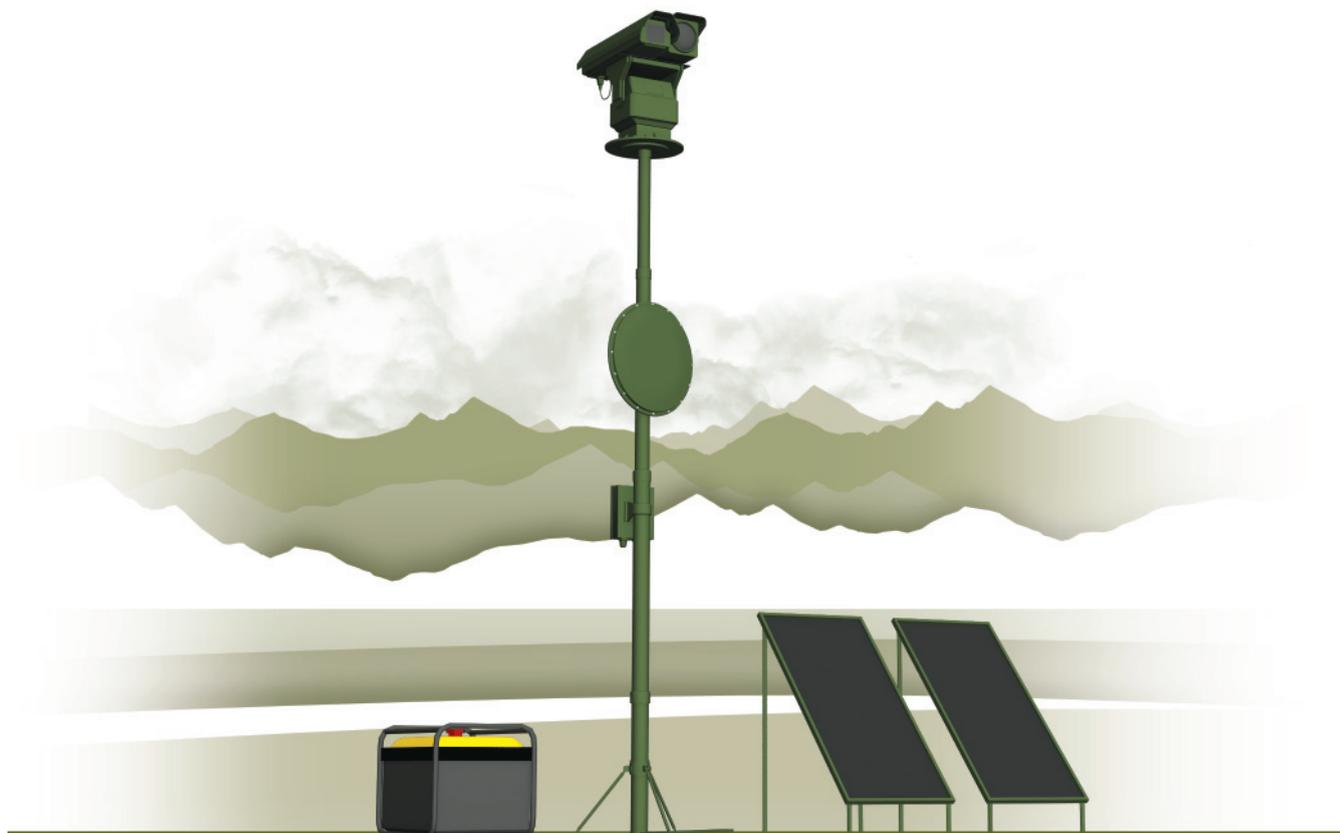
Комплекс предназначен для видео-тепловизионного наблюдения и охраны периметров, подступов и путей передвижения к важным объектам, удаленных от стационарных частей на значительное расстояние. Отличительными особенностями комплекса являются возможность его быстрого развертывания и длительная работа в автономном режиме.
