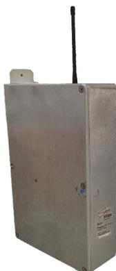
Блок подключения радиоканальных извещателей БРДМ, предназначен для беспроводного подключения радиоканальных извещателей STS-102, STS-105, STS-110 и передачи извещений на сервер. Является частью системы «РадиоРубеж». Передает извещения на сервер по протоколу Ethernet.
