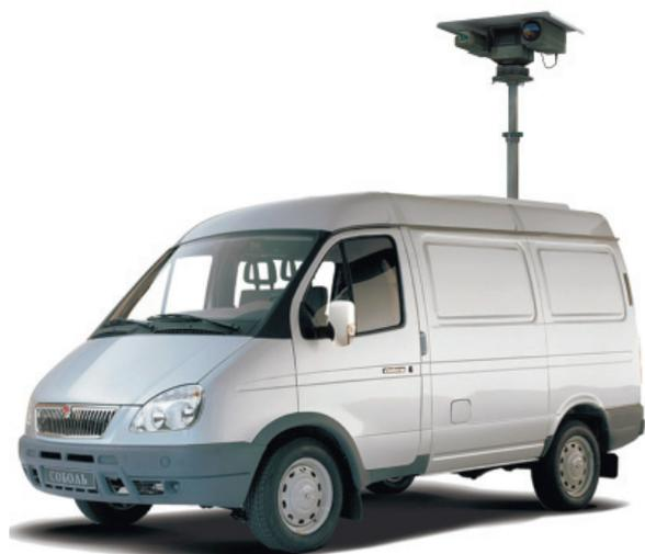
Автономный мобильный комплекс видео-тепловизионного наблюдения на базе автомобиля повышенной проходимости «Скорпион» (далее комплекс) предназначен для видео и тепловизионного наблюдения и охраны периметров, подступов и путей передвижения к важным объектам, удаленным от стационарных частей на значительное расстояние и предназначен для использования в качестве быстроразворачиваемого вспомогательного средства охраны.
