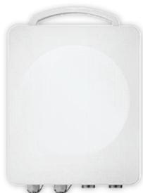
Контроллер представляет собой внешний блок с интегрированной антенной, применяемый для организации беспроводной передачи данных большой пропускной способности между двумя точками.
