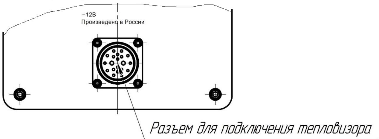
Подключение производится специализированным кабелем к разъему, расположенному на задней стенке корпуса.
